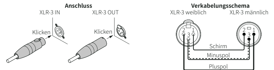
Abbildung 2. XLR-3-Anschluss und Kabel-Belegung.
