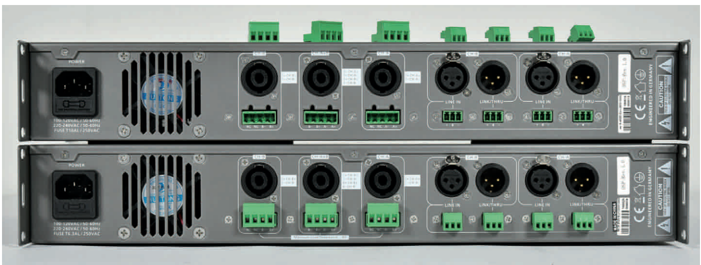
■ Doppelt ausgeführt neben den Speakon- und XLR-Buchsen gibt es für alle Ein- und Ausgänge auch noch jeweils eine Phoenix-Buchse
