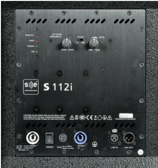
Subwoofer-Elektronikmodul Pegel, Trennfrequenz des Tiefpassfilters (80-250 Hz) und phase reverse können eingestellt werden
