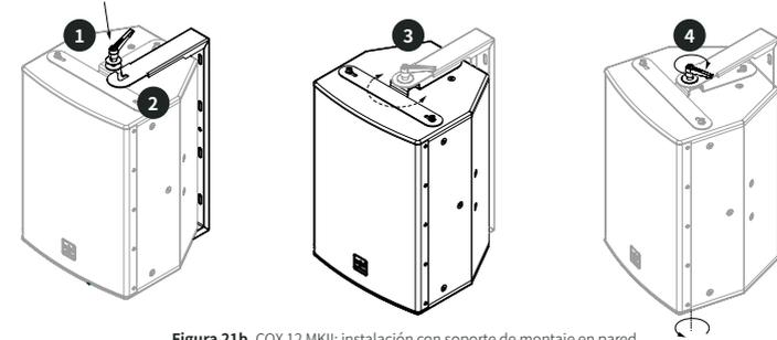
Figura 21b. COX 12 MKII: instalación con soporte de montaje en pared.
