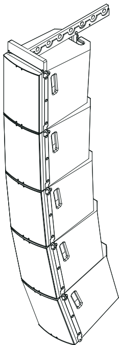
图45. 5只音箱组成的独立吊挂线阵列系统
